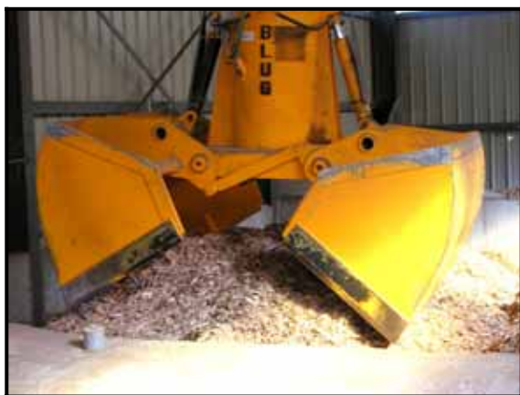
Grappin automatique (à gauche) et chaufferie bois (à droite)
