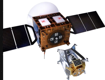
Ravitaillement d'un satellite (en haut) par une « navette-citerne » d'Orbit Fab (en bas).
