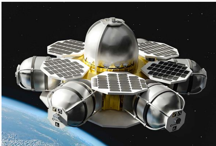
Le Tanker-002 d'Orbit Fab, un projet de dépôt d'hydrazine en orbite géostationnaire.
