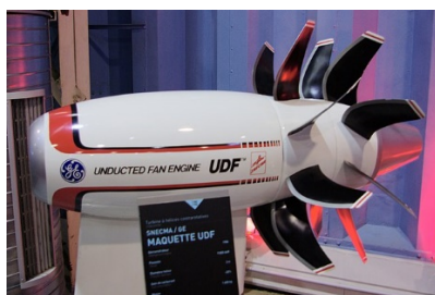
GE36 « propfan » (copyright : By Duch - Own work, CC BY-SA 4.0)
