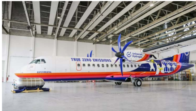
ATR-72 en cours de conversion à Blagnac (source : Universal Hydrogen)
